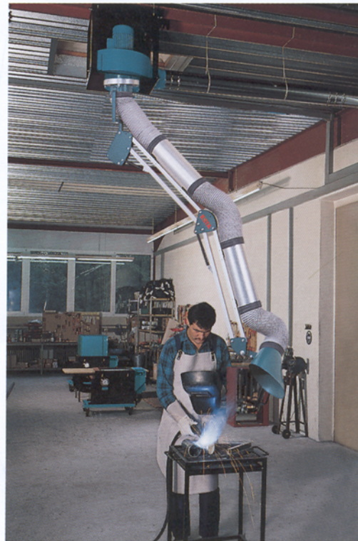
Optimaler Einsatz eines RG-200 Gebläses mit Kugelgelenk-Absaugarm
