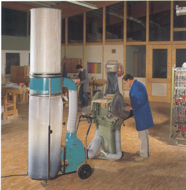
Fahrbare Staub- und Späneabsaugung mit Filterpatrone
