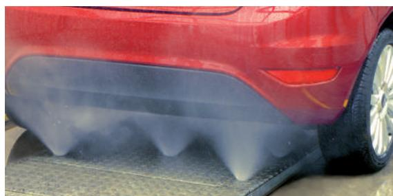
Lavage châssis fixe 90 L/min, 10 bar ou oscillant 120 L/min, 15 bar.
