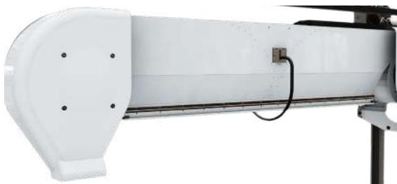
Séchage de 15,2 kW (4 x 3,8 kW) avec tuyère horizontale copiante et volet orientable en option pour un séchage optimal de la partie arrière du véhicule. Possibilité d'équiper le portique de 2 turbo-ventilateurs 4kW supérieurs fixes pour un séchage rapide, sans suivi de profil.
