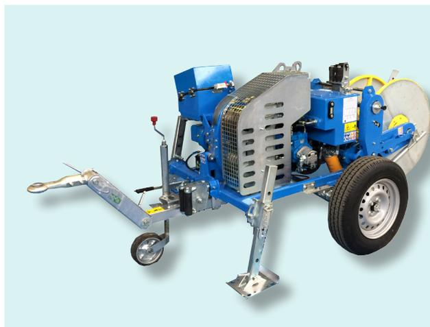
Treuil hydraulique conçu pour le tirage d'une câblette dans le déroulage de lignes électriques de transport aériennes et de câbles à fibre optique. Un circuit hydraulique fermé permet de varier en continu la vitesse de rotation des cabestans dans les deux directions en agissant sur un seul dispositif de contrôle.
