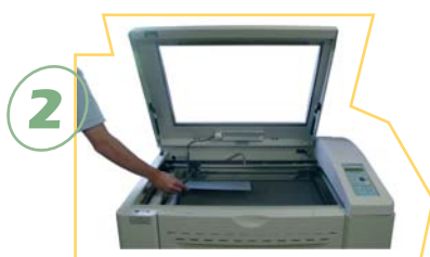
Mise en place de l'Alumamark dans la graveuse laser*
