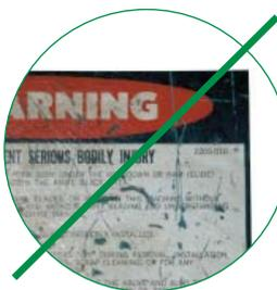
Avec les autres matériaux, l'abrasion peut rendre les étiquettes illisibles et inattractives. Le Metalphoto reste lisible même dans un environnement abrasif.
