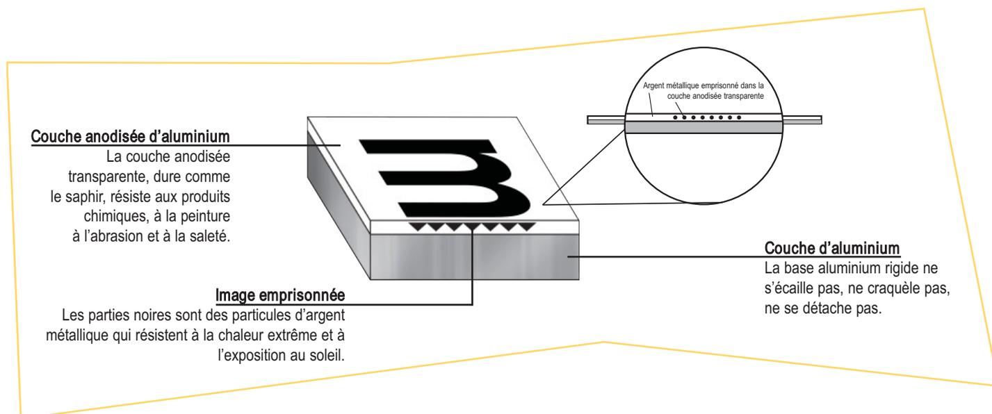
*Au fur et à mesure que le temps passe, votre produit peut être soumis à une ou plusieurs des conditions suivantes : Soleil, chaleur, nettoyage, manipulation, abrasion, saleté, fuel, peinture, impacts, brouillard salin, sable, produits chimiques, humidité, froid.*
