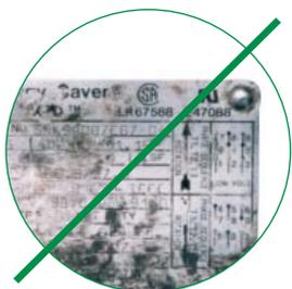
Les produits chimiques peuvent attaquer les autres matériaux, les rendant illisibles. La plupart n'ont aucun effet sur le Metalphoto.
