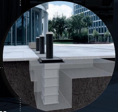
Vue en coupe d'un système complet composé d'une borne, d'un puisard de logement et d'une fondation renforcée.
