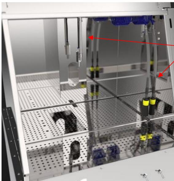
Photo, enceinte ouverte, avec pinceau de nettoyage autoalimenté en solvant + distributeur solvant nébulisé (avec air) pour rinçage final.
