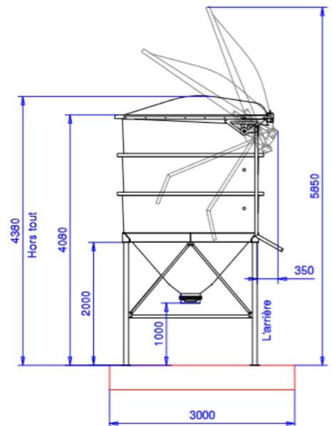
**Dalle béton 3.2 M x 3 M**
