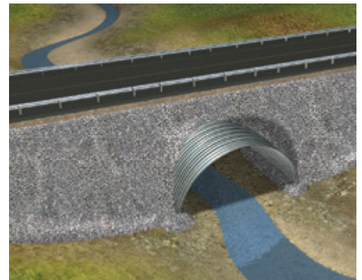
La couche de roulement et les glissières de sécurité sont ensuite ajoutées.
