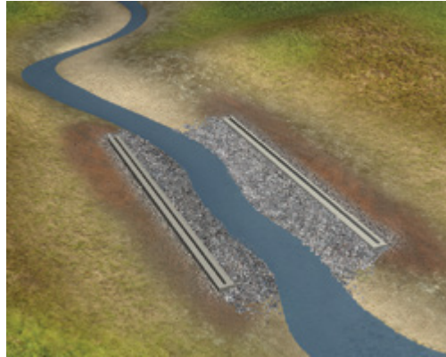
Les semelles en béton armé sont coulées sur le site préalablement préparé.
