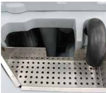
Nouveau système de collecte d'eau anti-éclaboussures avec récupération des débris
