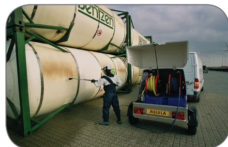
Nettoyage des citernes
