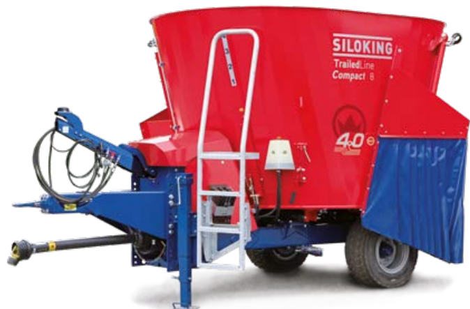
Les variantes de déchargement permettent d'adapter la mélangeuse fourragère à la configuration de l'exploitation.
