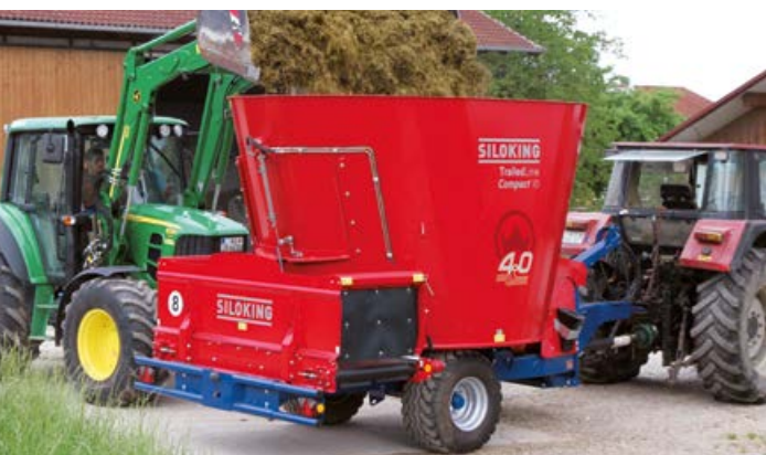
La solide protection anti-encastrement avec éclairage intégré assure la sécurité, de jour comme de nuit.
