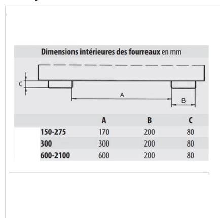
Voir en ligne Benne basculante à copeaux type EXPO-E
