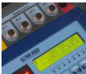
AFFICHEUR LCD RETRO ECLAIRE capable d'afficher le poids de chaque plateforme et le centre de gravité.
