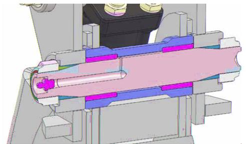
Ce système permet une élimination du jeu entre la broche et douille causée par l'usure par serrer les écrous de la goupille.
