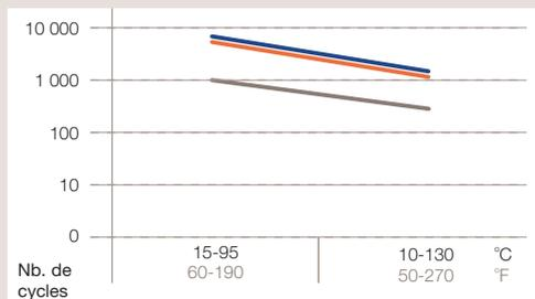
Différents types d'échangeurs de chaleur à plaques brasées ont été testés afin de comparer leur résistance à la fatigue et à la pression thermique.
