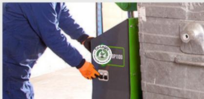
Commande à deux mains pour une sécurité renforcée et système unique de plancher élévateur pour protéger le fond de la benne
