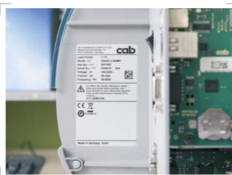
Marquage de plaques signalétiques
