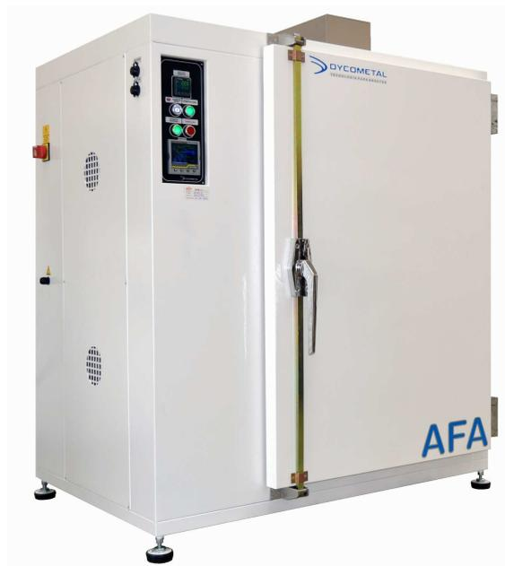
Les Étuves AFA ont été conçues pour vous permettre de maîtriser des conditions en hautes températures, soit en stabilité (version manuelle « M »), soit pour réaliser des cycles thermiques (version programmable « P »).
