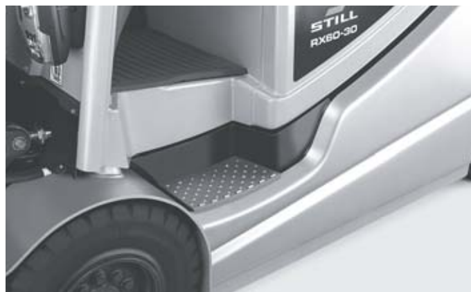
Haute sécurité et fluidité d'accès à bord – grâce à un marchepied antidérapant largement dimensionné
