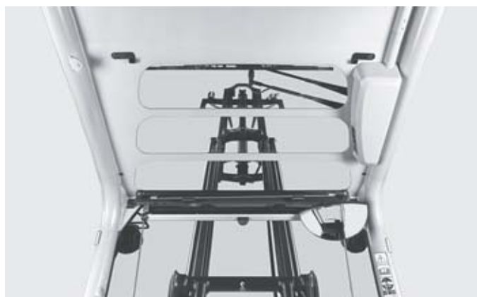
Haute précision et sécurité des prises et déposes de charges grâce à un contrôle visuel optimal vers l'avant et en hauteur
