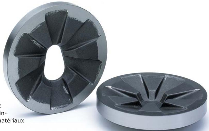
Les disques de broyage présentent une usure naturelle après une longue utilisation. Cependant avant de les remplacer par de nouveaux disques, on peut utiliser le côté opposé de la denture en inversant le sens de rotation du moteur. La durée de vie des disques est ainsi nettement prolongée.
