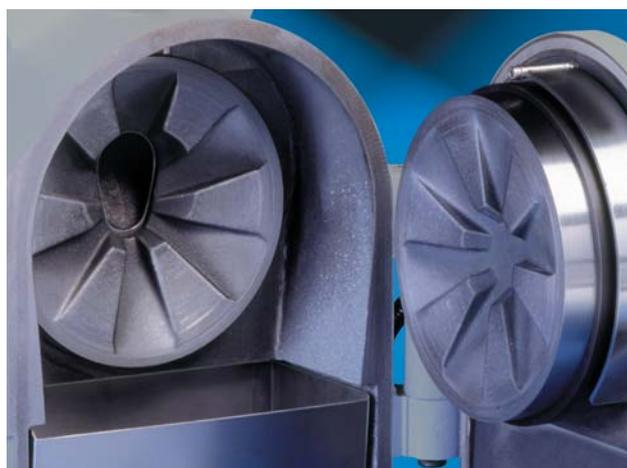
*Compartiment de broyage du DM 200 (disques de broyage à denture progressive)*
