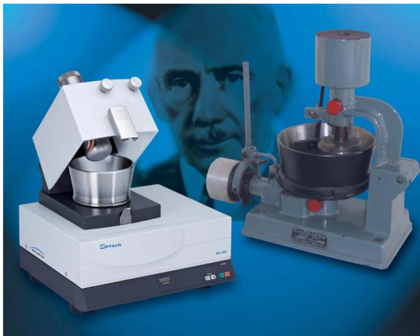
**Les broyeurs à mortier et les broyeurs à disques RETSCH** sont essentiellement utilisés pour le broyage fin et ultra-fin de matériaux mous, durs et cassants. Les finesses finales obtenues avec les broyeurs à disques sont d'environ 100 µm et avec les broyeurs à mortier de <math><10\ \mu\text{m}</math>. Suivant l'appareil utilisé, la taille initiale est de 20 mm maximum. Si la matière chargée a une plus grosse granulométrie, elle devra alors être prébroyée.
