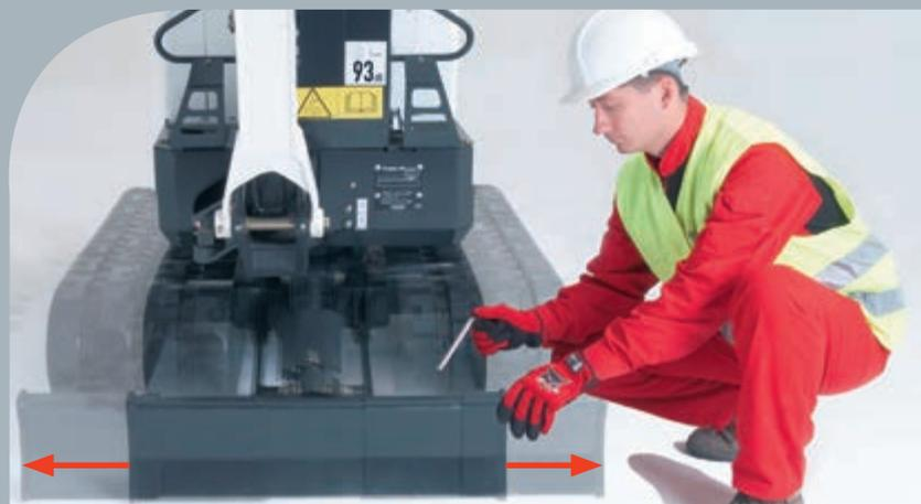
Les modèles E08 et E10 sont tous deux équipés de série d'un châssis inférieur à voie variable et d'une lame extensible. Les rallonges de lame coulissantes font partie de la lame : il n'est plus nécessaire de les monter ni de les démonter.
