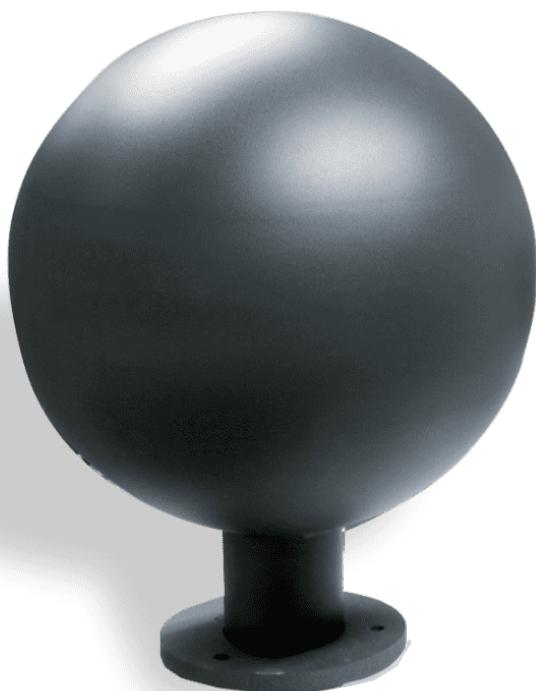
Borne fabriquée en acier avec traitement Ferrus, procédé qui protège le fer et garantit une résistance optimale à la corrosion. Le traitement Ferrus consiste en trois couches appliquées à la suite du nettoyage de toutes les impuretés par greaillage : zingage, couche époxy et une couche de peinture poudre polyester teinte noir forge.
