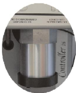
Pour répondre aux exigences des normes EN 14907 (PM-2.5) et EN 15549 (BaP), le magasin de stockage peut être équipé en option d'un refroidisseur par effet Peltier qui garantit que la température de stockage des filtres ne dépasse pas les valeurs fixées par les normes. Les performances des refroidisseurs Peltier ont été vérifiées par le TUV (certificat de test disponible sur demande).
