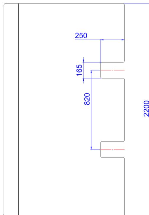
Cette rampe se déplace facilement grâce aux deux échancrures sur sa face supérieure à l'aide d'un chariot élévateur.
