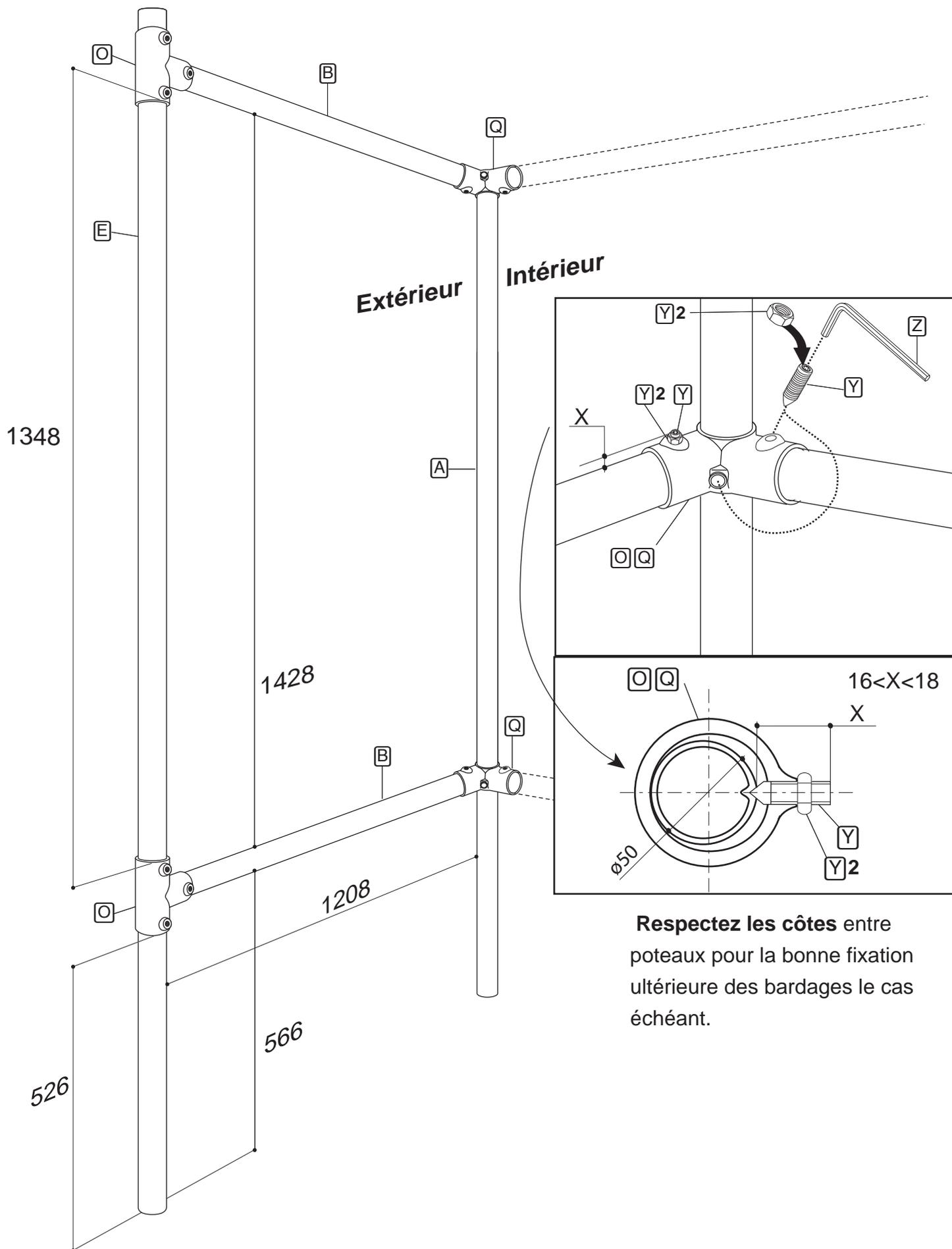
**Respectez les côtes** entre poteaux pour la bonne fixation ultérieure des bardages le cas échéant.
