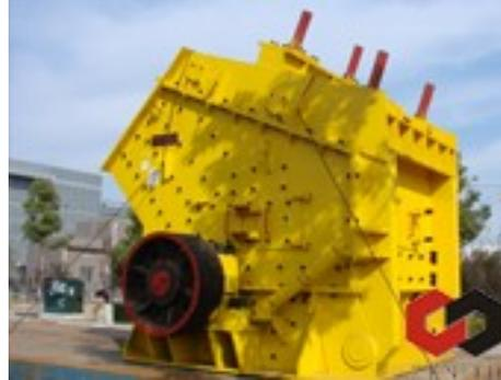
Après la technique avancée d'introduction, le concasseur à percussion est optimisé et amplement appliqué dans le premier et deuxième concassage. Il peut concasser le matériel comme le granite, le basalte, la bluestone, etc...le côté le plus longue est moins de 500mm et la vigueur de contre-pression est pas plus que 320Mpa, le produit final est l'équipement idéal pour l'agrégation employé dans l'autoroute et la surface du chemin de fer autant que l'industrie de l'eau et l'électricité.
