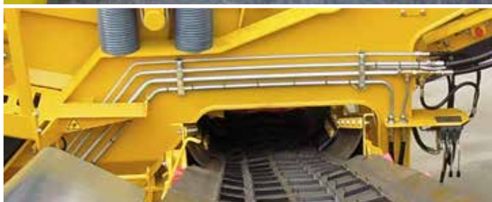
Lignes hydrauliques en acier
