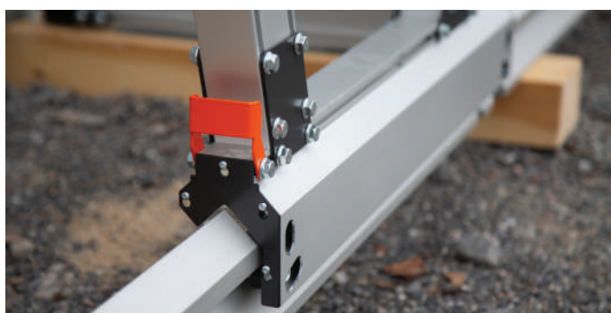
Le chariot de la scie glisse facilement sur le rail, sans aucun jeu.
