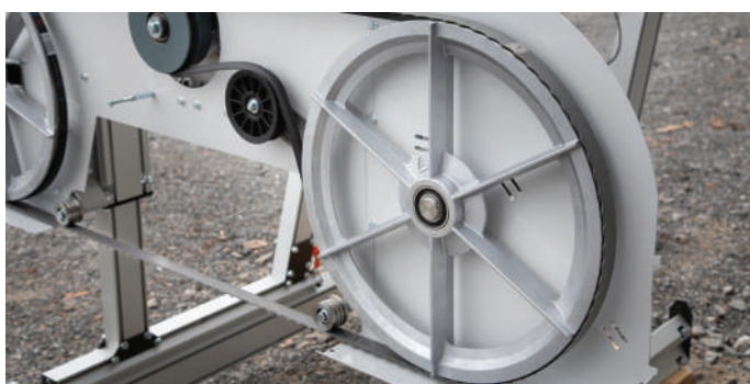
Volants avec des pales de ventilateur, qui refroidissent la lame et maintiennent le couvercle propre.
