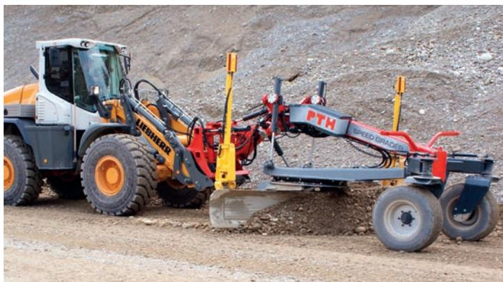
La couronne d'orientation permet de supporter les charges les plus lourdes, le réglage de l'angle de coupe de la lame est extrêmement précis.
