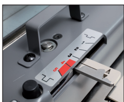
Réglage de la profondeur de rainage
