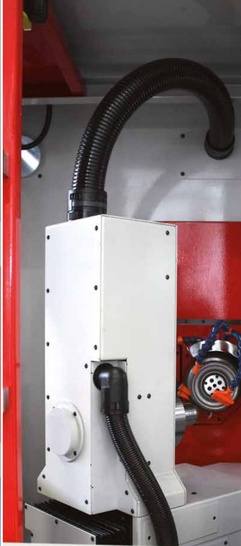
Lunette de support et contre-pointe automatique pour l'affûtage ou la construction de petits outils (en option)
