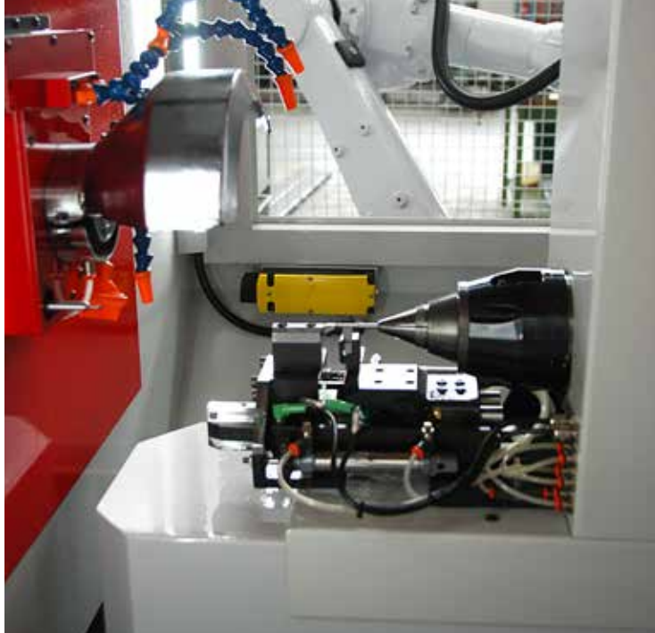
Lunette de support et contre-pointe automatique pour l'affûtage ou la construction de petits outils (en option)
