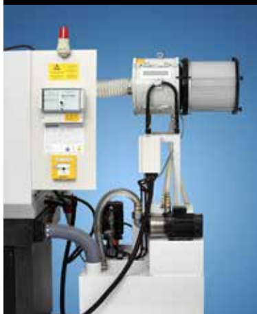
Installation externe de filtrage d'huile avec réservoir et pompe à haute pression. Aspirateurs des fumées et brouillards d'huile (en option)
