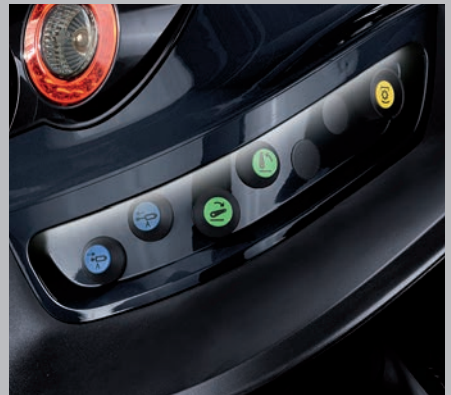
Eclairage Led pour contrôle extérieur(7250 TTV)
