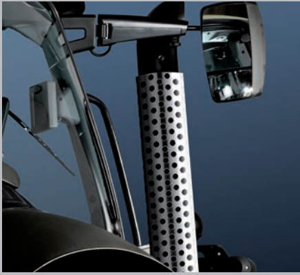
Echappement avec garniture en acier inoxydable (7250 TTV/9340 TTV)
