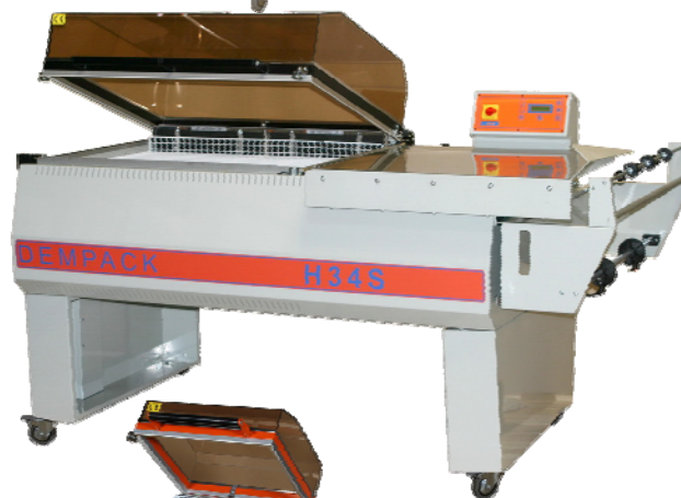
DEMPACK H 34 cadre de soudure de 870 x 620 mm la Plus grande de la gamme sans
