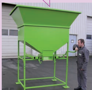
FG rehaussée avec accès levier en façade
