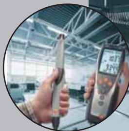
Sonde spécifique trois fonctions pour mesure de la qualité d'air intérieur
