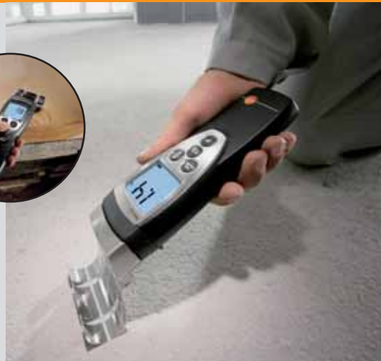
Contrôle d'humidité sur une chape. La mesure de plusieurs points sur toute la surface assure une plus grande sécurité de la mesure.
