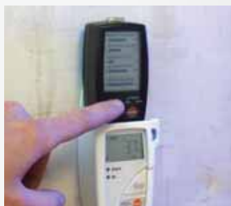
Collecter les données sur site, les lire et les exploiter de manière centralisée sur le PC. Aucun problème avec le testo 580, le collecteur de données
