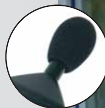
Micro déporté avec capuchon de protection
