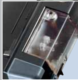
Piège à condensat – préparation des gaz Peltier intégrée avec pompe à tuyau pour éliminer les condensats en vue d'une mesure longue durée sur plusieurs heures
