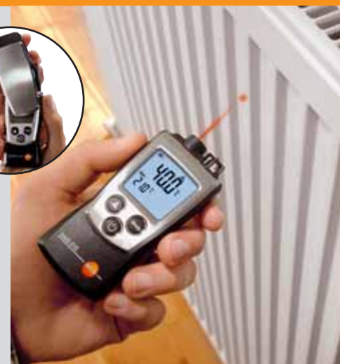
Contrôle de température sur un radiateur
