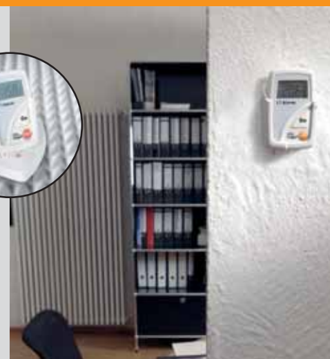
Enregistrement de température ambiante avec alarme immédiate lors de dépassement de seuil haut ou bas
