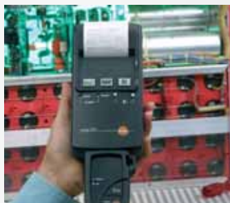
Impression rapide sur site des valeurs enregistrées avec départ possible de l'enregistreur grâce à l'imprimante testo 575
