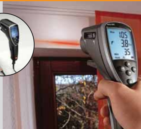
Entrée de sonde TC pour la détermination du degré d'émissivité (voir sondes 925/922 page 26)
