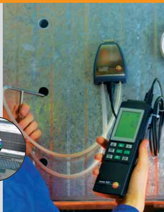
Mesure à l'aide d'un tube de Pitot avec sonde externe 100 Pa
