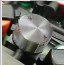
Module de mesure infrarouge (NDIR) pour une détermination directe du CO 2
