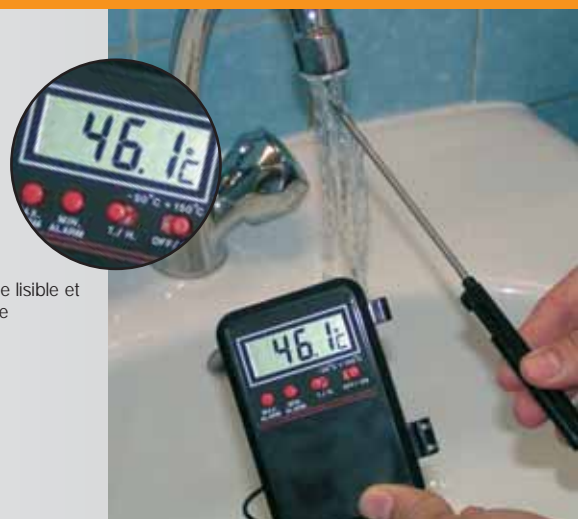
Mesure de la température de l'eau chaude
