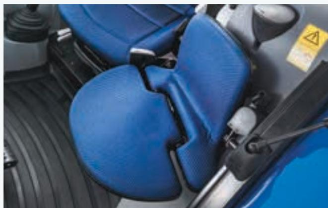
Le grand siège d'instructeur, en tissu, avec ceinture de sécurité complète l'étendue de l'offre sièges New Holland.
