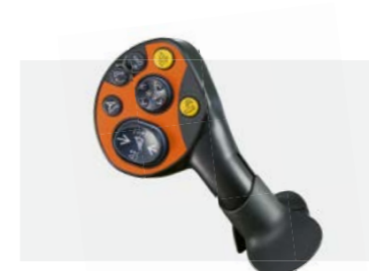
Poignée multifonction standard plus compacte que la poignée CMOTION
