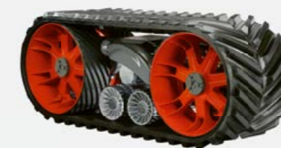
TERRA TRAC 890 mm avec roues à rayons
