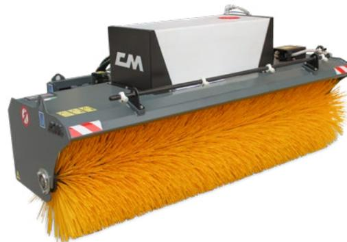
Sans le bac de ramassage mais avec uniquement les brosses en polypropylène. Elle fonctionne avec le circuit hydraulique de la machine opérationnelle, elle est produite en 9 modèles avec des largeurs de travail utiles de 105 à 300 cm.
