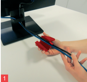
1 Couper la gaine à la longueur souhaitée. Rassembler tous les câbles dans l'outil. Fermer l'outil.
