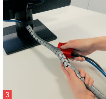
3 Maintenir la gaine avec une main et faire glisser l'outil : les câbles sont «avalés» par la gaine.
