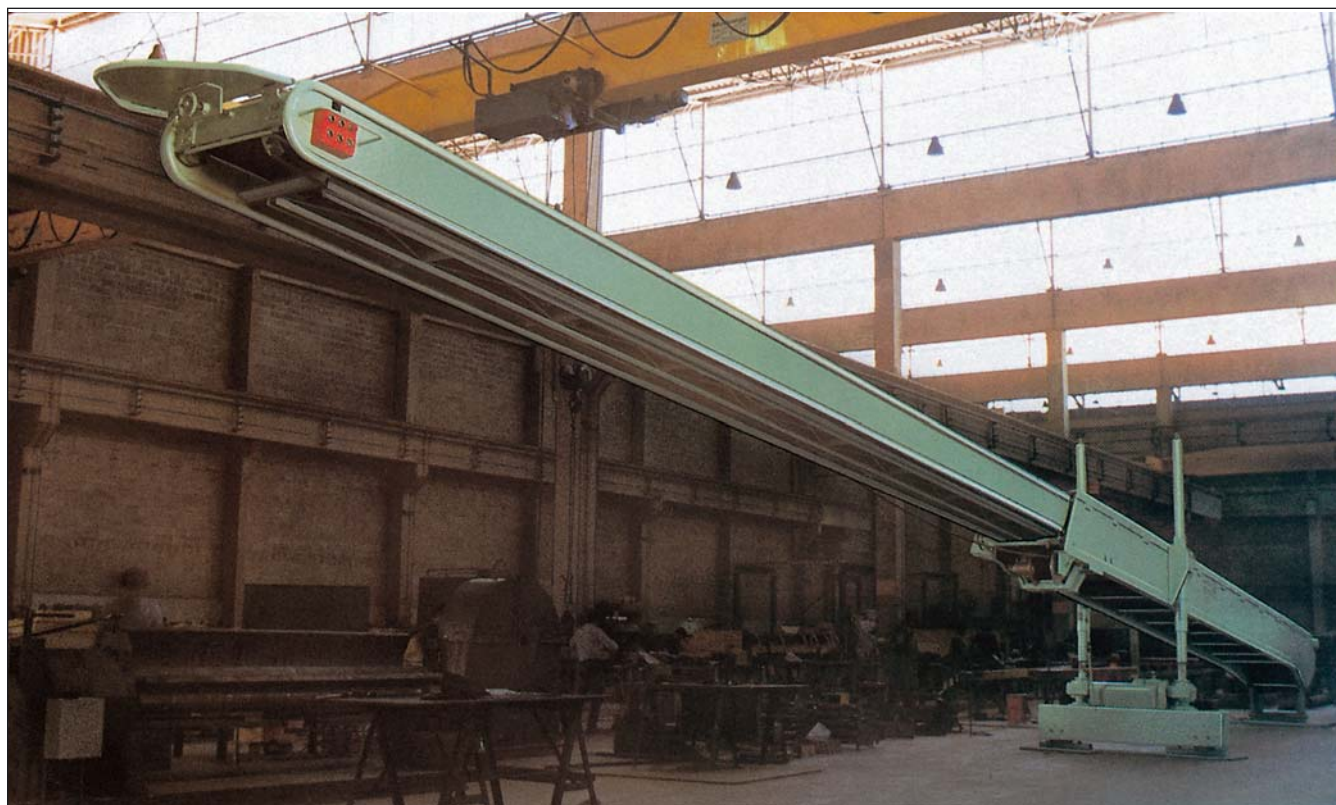
Modèle spécial - machine télescopique pour le chargement de camions par l'arrière.
