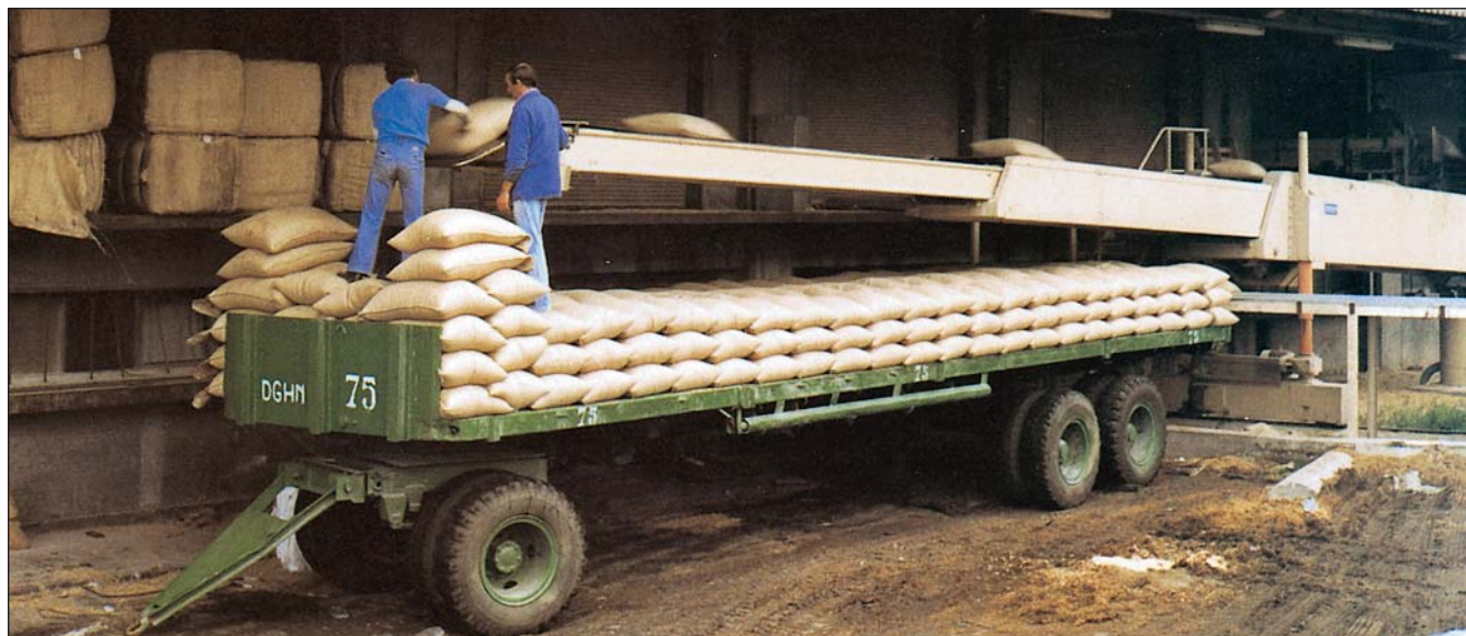
Modèle spécial - machine pour le chargement de camions par l'arrière, double exécution télescopique.
