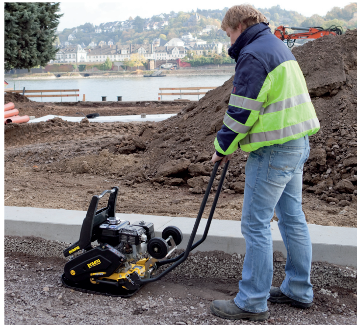
BP 10/35 : petite et légère pour les utilisations dans les coins et dans les zones difficilement accessibles.
