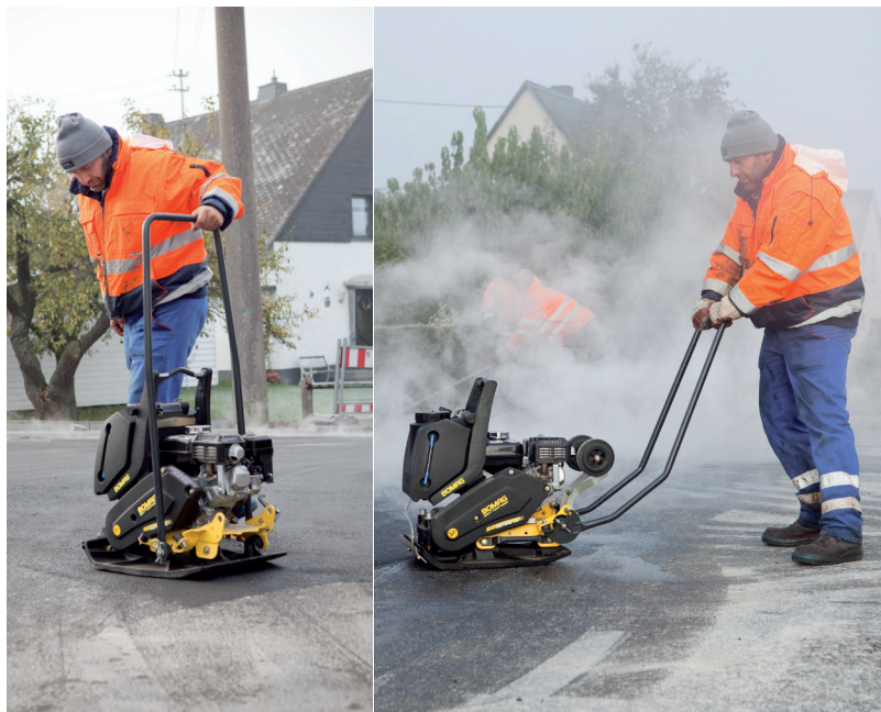
Point d'attache central (en option) : pour une meilleure manipulation et une plus grande manœuvrabilité.
