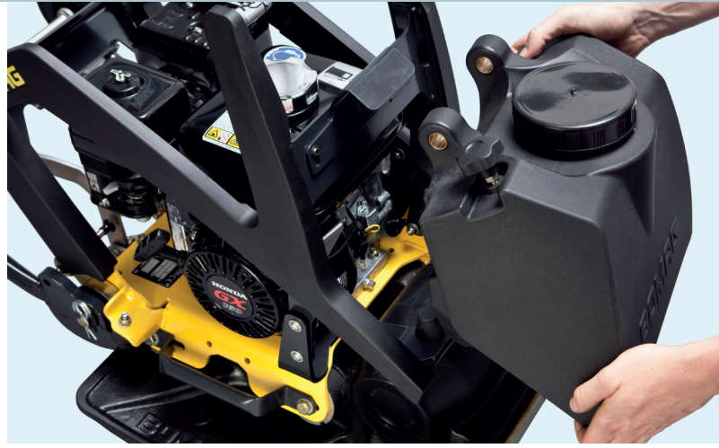
Réservoir d'eau amovible pour un remplissage simple et rapide.
