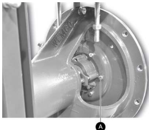
Figure 34 Les 6 vis de fixation (A) du boîtier presse-étoupe.
