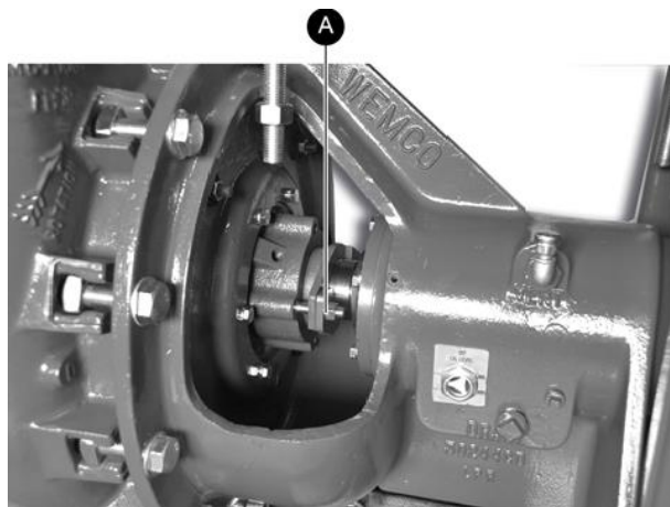
Figure 24 Agir sur les deux écrous (A) pour régler le goutte à goutte.
