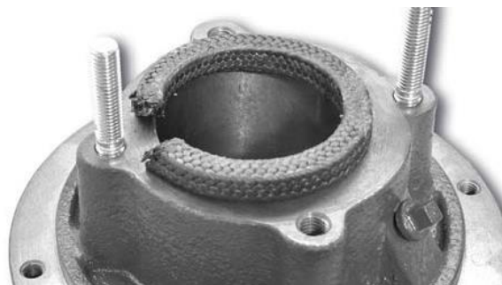
Figure 39 Mise en place de la tresse et positionnement des deux bords de coupe inclinés de la tresse.
