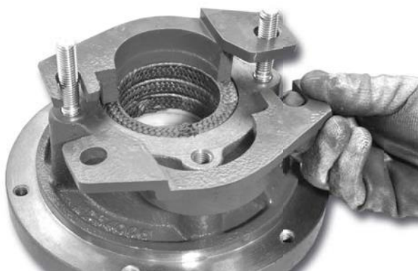
Figure 43 Mise en place du fouloir de presse-étoupe et de ses écrous.
