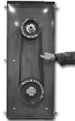
Figure 19 Contrôle visuel de la tension des courroies,
