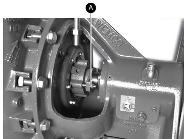
Figure 53 Les écrous de réglage du fouloir de presse-étoupe.
