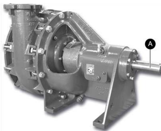
Figure 6 Vérification de l'absence de point dur mécanique sur l'arbre de pompe.
