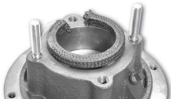
Figure 41 Mise en place de la deuxième tresse et positionnement des bords de coupe inclinés de la tresse.
