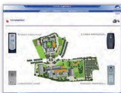
Logiciel de supervision graphique des communications, du contrôle d'accès, alarmes techniques...
