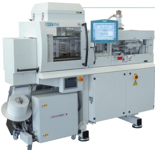
Flux laminaire autonome avec système d'ensachage en ligne, pour la production de pièces «propres»
