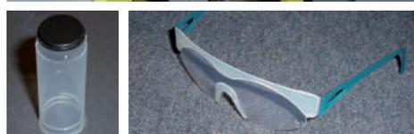
Voici une solution de moulage par injection à deux composants. Elle associe une machine BOY 35E (force de verrouillage de 350 kN) à une unité d'injection installée à la verticale. L'exemple ci-contre nous présente des lunettes de sécurité moulées. Les verres, la barre de front ainsi que le pont de nez ont été réalisés avec du PP (polypropylène) haute transparence.
