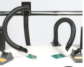
Les bras BVX (Ø 50 mm) constituent la plus économique des solutions, tout en assurant d'excellents débits d'air et une grande souplesse d'emploi. Le conduit spiralé peut être rigidifié et positionné avec précision. Le kit BVX-ARM-K2 comprend une plaque de fixation et des pinces de montage. Un raccord en Y permet de raccorder deux bras BVX à un seul tuyau.
