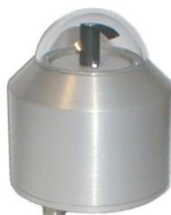
Tête de mesure de rayonnement global FLA 613 GS-SDEK, mesure du rayonnement solaire global, direct et diffus (étrier d'ombre intégré), sensibilité spectrale 380 nm jusqu'à 1100 nm.
