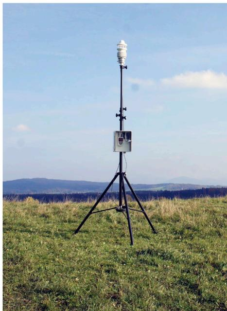
Station météo universelle à utiliser en déplacement pour mesurer direction et vitesse du vent, la température, l'humidité de l'air, la pression atmosphérique, les précipitations et le rayonnement global. Facile à installer, exécution robuste, différentes centrales d'acquisition ALMEMO® V7 possibles.
