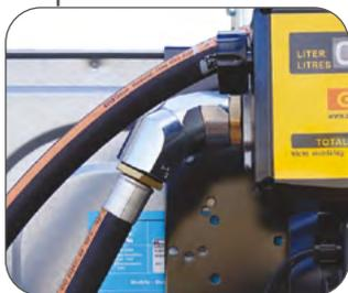
Raccord tournant en sortie de compteur
