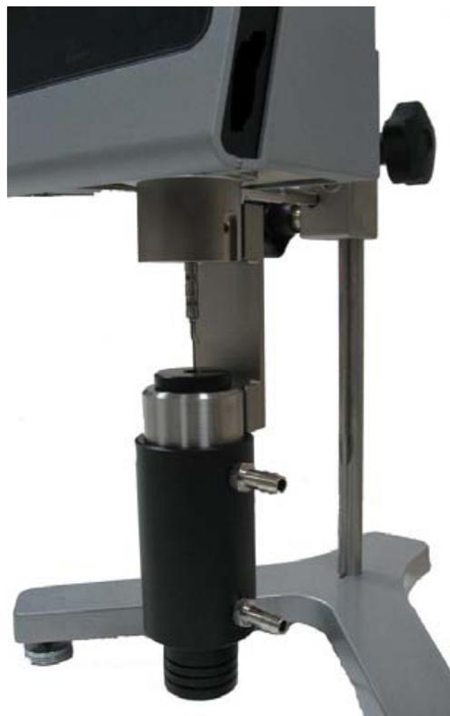
Fig.8: Adaptateur LCP monté sur le viscosimètre
