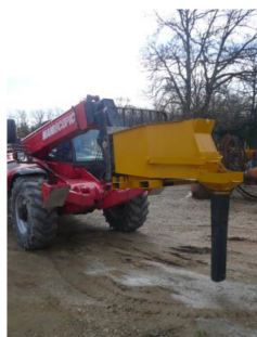
Benne BSB équipée d'un tuyau longueur 1m reprise au chariot élévateur.
