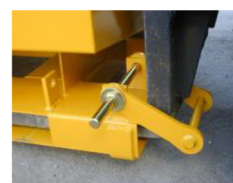
Système de blocage des fourches pour sécuriser la manutention au chariot élévateur
